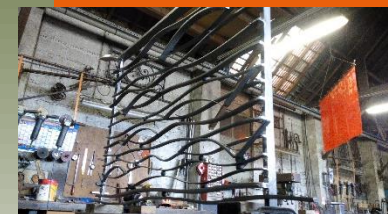
Réalisation de la balustrade en fer forgé
